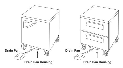
**Model** TUR-28SD-N, TUF-28SD-N, TUR-28SD-D2-N, TUF-28SD-D2-N
